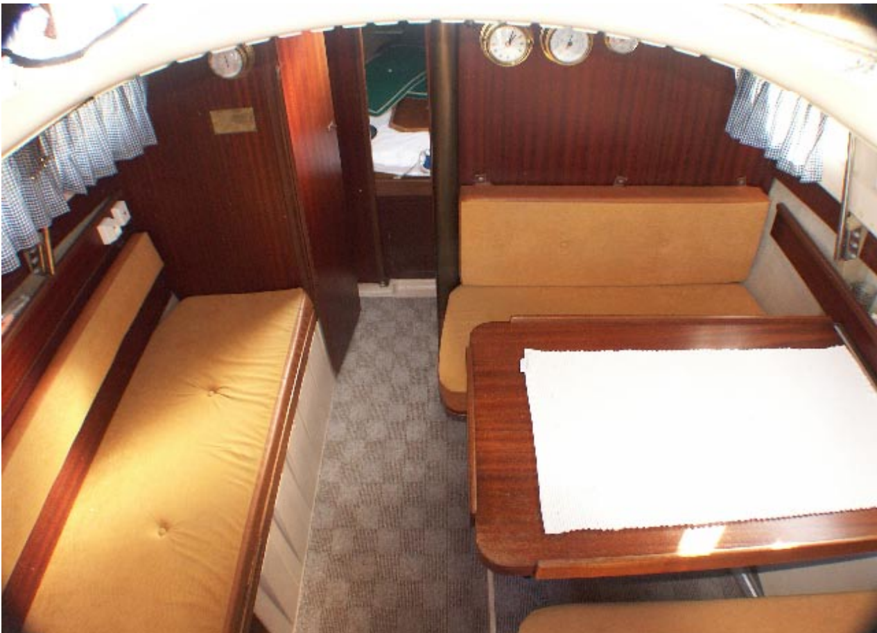
Eine Dinette-Version der Delanta 75. Der Innenraum ist recht schnörkellos, aber durchaus praktisch ausgebaut, die Platzverhältnisse sind für eine drei- bis vierköpfige Crew akzeptabel. Nach dem Absenken des Tisches steht eine weitere Koje zur Verfügung
