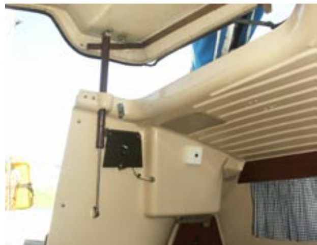
Ein Hubdach sorgt für Stehhöhe und viel Luft unter Deck. Häufig klemmen die Gasdruckfedern, Ersatz ist aber leicht zu beschaffen
